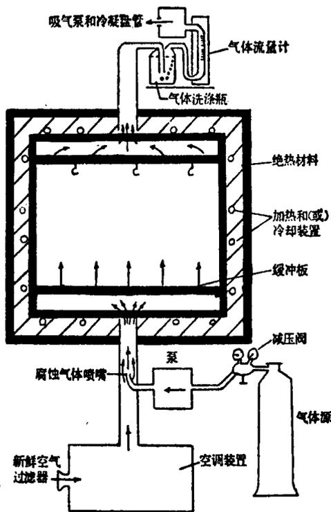
附图 带有产生试验气体装置的试验设备简图
